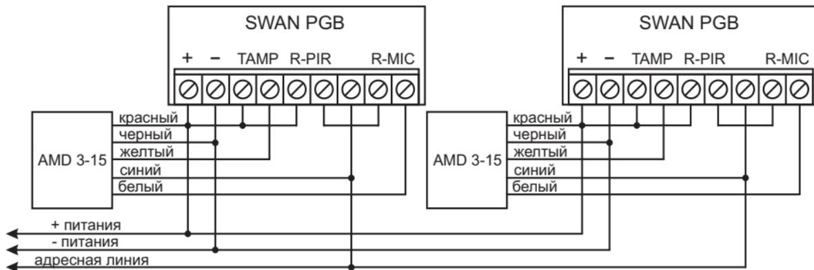
Назначение проводов модуля AMD 3-15:
