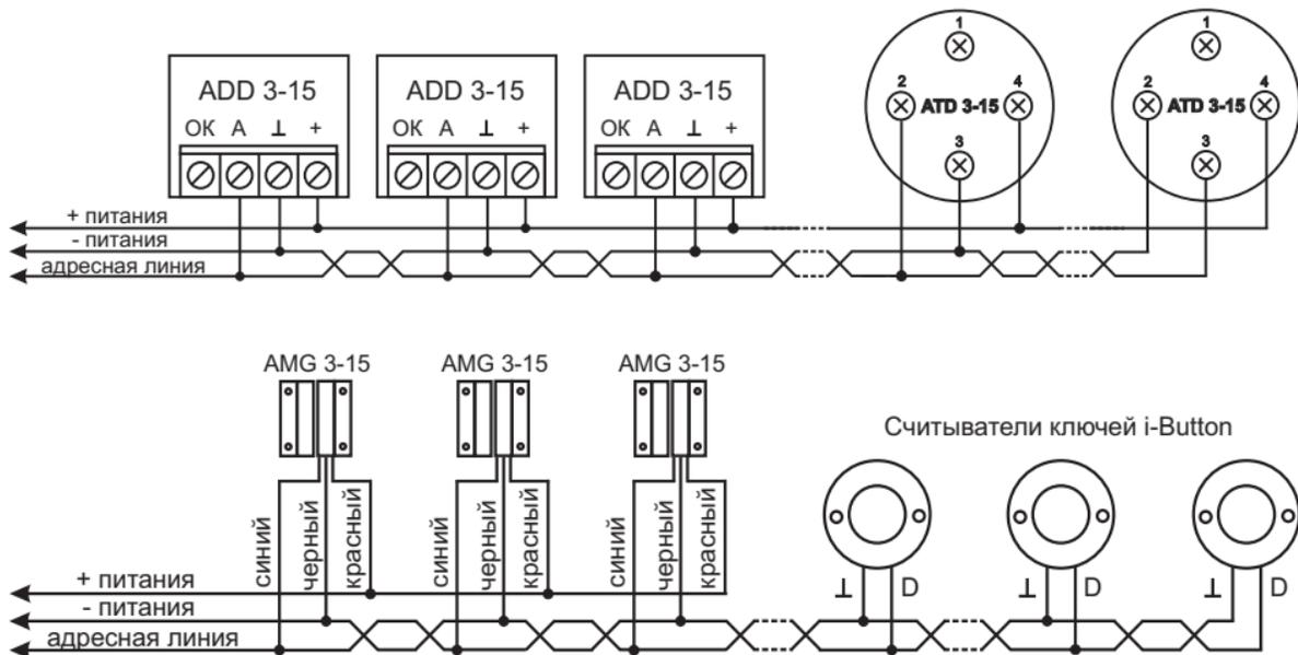
При использовании витой пары «адресную линию» и «- питания» подключать, используя одну пару кабеля.
